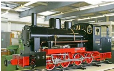
5 " Schmalspurlok Nr. 994633 der Rügenbahn M 1:5.9 Länge 1280mm, Breite 380 mm, Höhe 540 mm, Gewicht 180 kg
