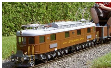
5 " BLS 6/8 der Bern-Lötschberg-Simplonbahn M 1:10 Länge 2030mm, Breite 380 mm, Höhe 540 mm, Gewicht 150 kg
