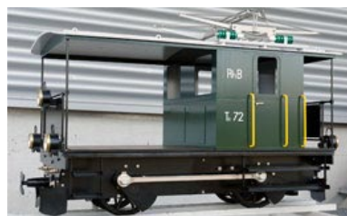
7 1/4" RhB Traktor Nr. 72 der Rhätischen Bahn M 1:4.5 Länge 1360mm, Breite 560 mm, Höhe 875 mm, Gewicht 200 kg
