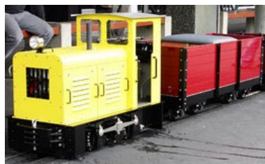
5" Feldbahndiesel Ns 2f PM-Motor 500W/24V, M 1: 4.8 Länge 660mm, Breite 350mm, Höhe 500 mm, Gewicht 90 kg Antrieb
