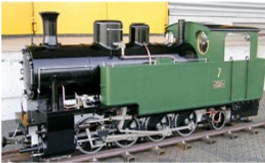
5 " Schmalspurlok WB7 der Waldenburgbahn M 1:5.9 Länge 1350mm, Breite 380 mm, Höhe 540 mm, Gewicht 250 kg
