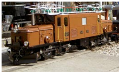
7 1/4 " Schmalspurlok Krokodil der Rhätischen Bahn M 1:4.5 Massstab 1:4.5, Länge 2950 mm, Breite 600mm, Gewicht ca. 1100 kg, kleinster befahrbarer Radius 10m
