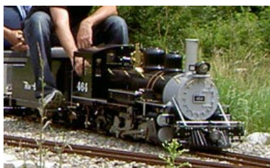
5" Rio Grande Schmalspur Schlepptender Lokomotive Baldwin K27 M 1:7 Länge über Schlepptender 2720 mm, Beite 400 mm, Höhe ab SO 580 mm, Gewicht ca. 250 kg
