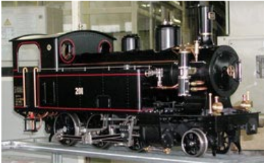
5 " SBB Schmalspurlok H 3/4 der Brünigbahn M 1:8 Länge 1100mm, Breite 330 mm, Höhe 500 mm, Gewicht 85 kg
