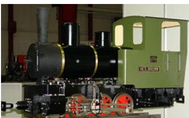
7 1/4" Feldbahnlok M 1:3 Heilbronn Länge 2000mm, Breite 630mm, Höhe 986mm, Gewicht 550kg
